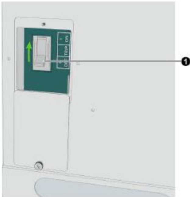
Abb. 4 – BMS Schalter (1) in Stellung Off bringen
