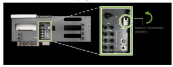
• anschließend schalten Sie den Solar Drehschalter auf Stellung "O" (dieser befindet sich links "unter" dem S10 Hauskraftwerk. Siehe Bild)
